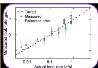
> Processo di calibrazione: foto della perdita controllata e grafico di correlazione tra la perdita reale (ascisse) e quella ricavata dalle misurazioni
