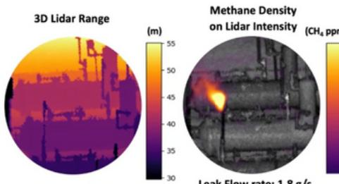
> Esempio di rilevamento e quantificazione perdita
